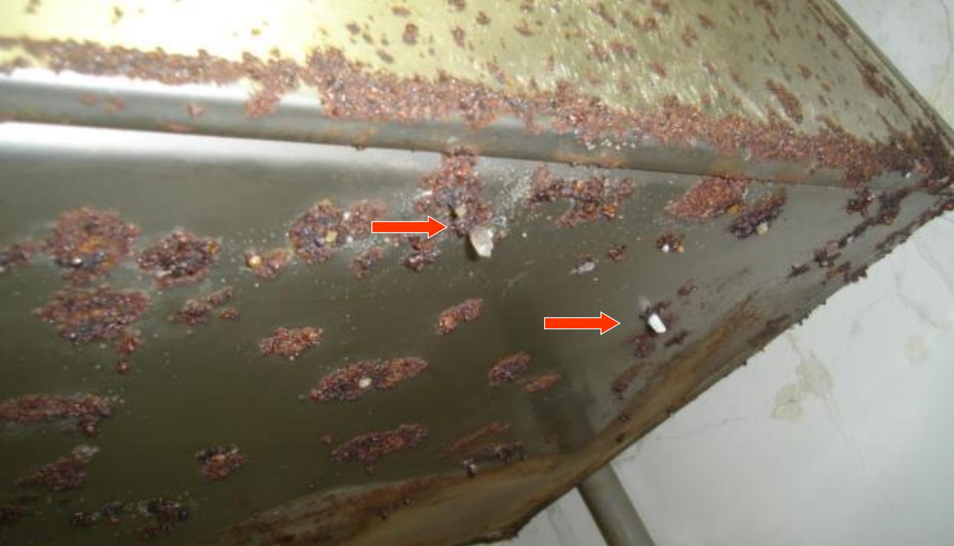
Para impedir o ingresso de poluentes agressivos nestes ambientes confinados tais como Subestação de potência, salas de painéis, poço de cabos, salas de baterias, casa de bombas, sala de compressores, etc temos que projetar **Enclausuramento e Pressurização**, ambientes confinados **redução de 66% nas taxas de corrosão entre uma instalação abrigada e instalação ao tempo**
